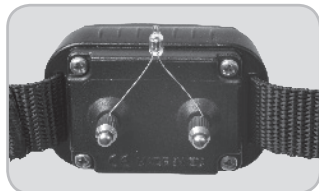
Colocación de la lamparita de comprobación
